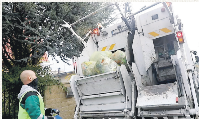
Śmieciarka dwukomorowa może odebrać jednocześnie dwa różne rodzaje odpadów
