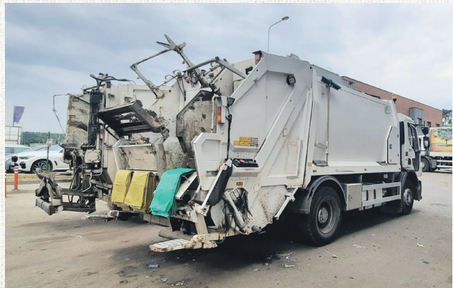
Śmieciarka dwukomorowa, dzięki dwóm osobnym komórkom ma możliwość odbierania np. tworzyw sztucznych z metalami i szkła
